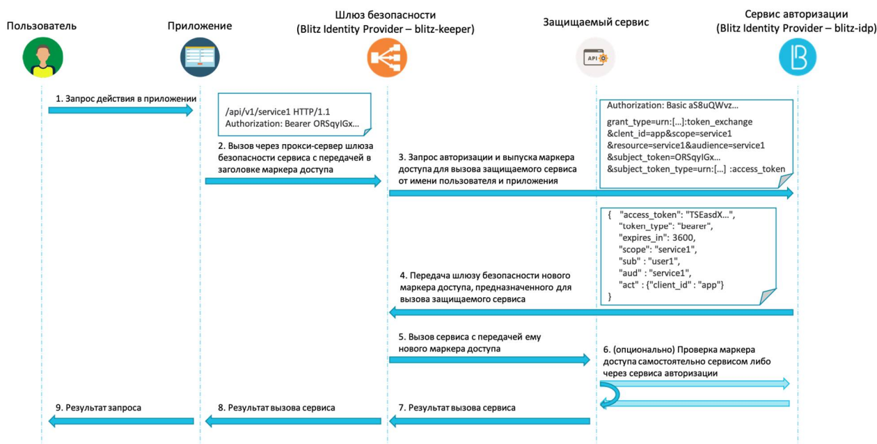
Рисунок 163 – Схема взаимодействия при вызове приложением защищаемого сервиса
