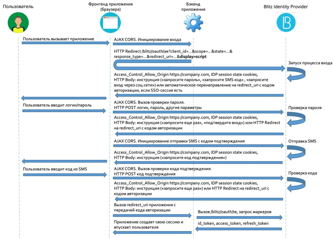
На следующем рисунке приведена схема взаимодействия при входе по телефону и коду подтверждения, отправляемому по SMS.
